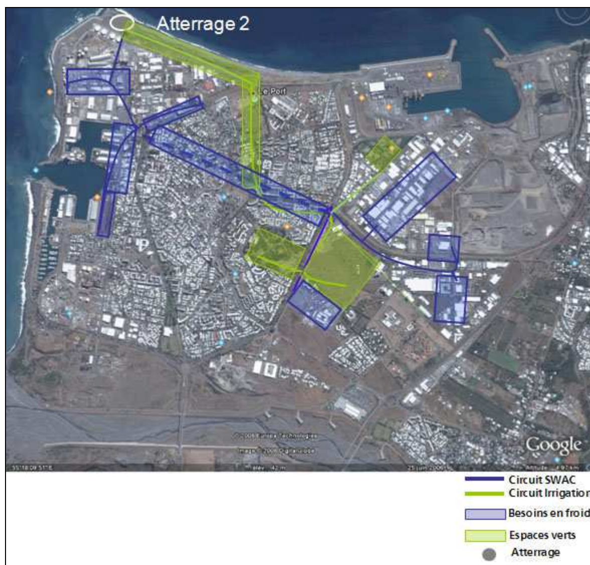
Figure 31 : Circuit de SWAC et d'irrigation au Port à partir de l'atterrage de la Pointe des Galets (Att 2)
