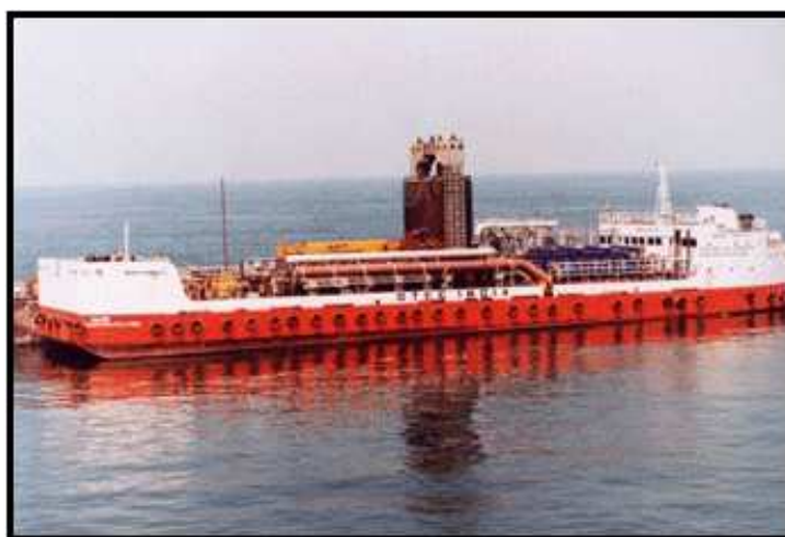
Figure 6 : Sagar Shakthy, centrale ETM d'1MW née de la coopération Indo-Japonaise
