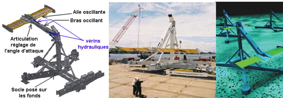
Figure 7.19. Système Stingray (Engineering Business Ltd) à aile hydrofoile : dessin, photographie du prototype et vue d'artiste d'une ferme sous marine [EB 03].
