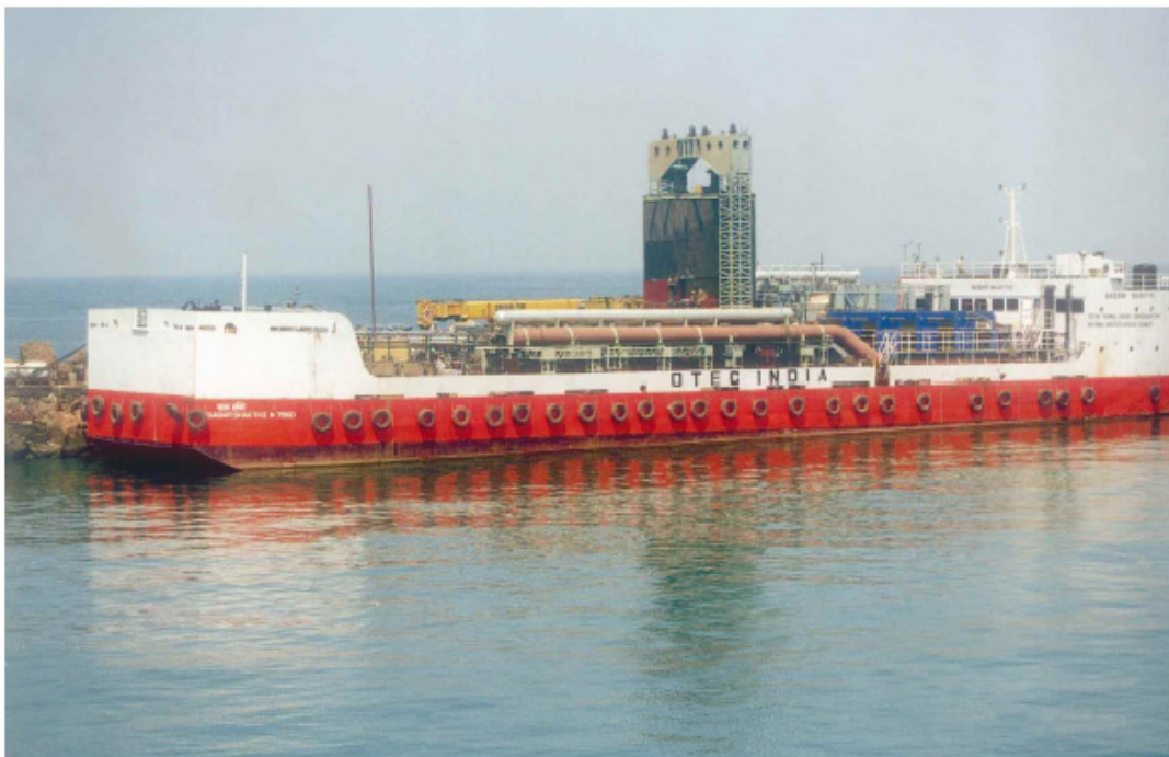
Figure 13 : Photo de la Barge ETM indo-japonaise « Sagar Shakthi » porteuse d'une centrale ETM expérimentale de 1MW.
